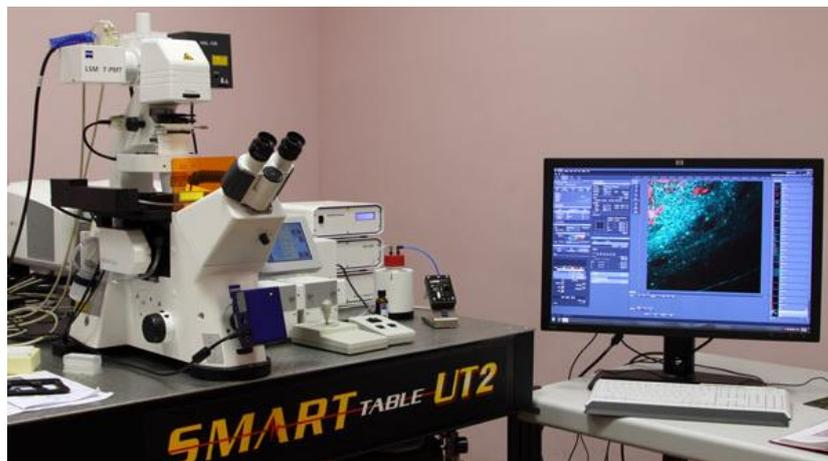
Лазерный сканирующий конфокальный микроскоп Carl Zeiss LSM-710 с короткоимпульсным фемтосекундным инфракрасным лазером.
